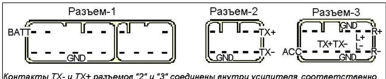
Контакты TX- и TX+ разъемов "2" и "3" соединены внутри усилителя соответственно Рис.6. Разъемы усилителя Pioneer (Lexus GS300)
